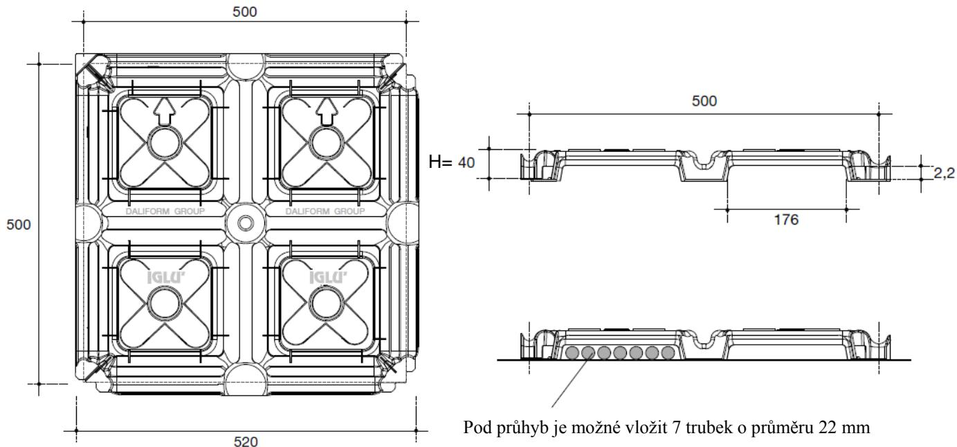
Rozměry jsou uváděny v mm s tolerancí +- 1,5%.
